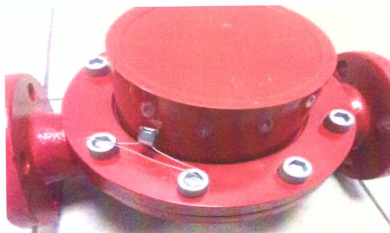
Рисунок 2 – Место установки заводской пломбы
