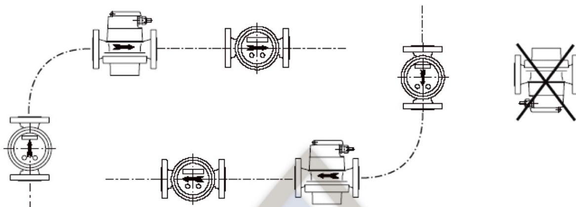
Проводка трубопровода должна обеспечиваться таким образом, чтобы измерительный прибор был всегда заполнен жидкостью и чтобы в ней не было никаких включений воздуха или газа.
