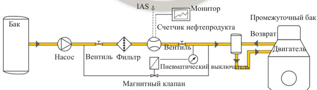
При падении уровня топлива в промежуточном баке происходит автоматическая подкачка топлива до необходимого уровня. Следует избегать образования газа в промежуточном баке. Перепускной клапан (магнитный клапан) открывается, когда давление падает ниже установленного значения. Если двигателей несколько, для каждого из них требуется своя полная установка.
