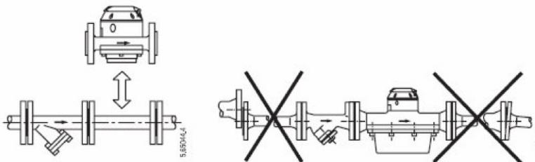
В трубопроводах из медных или тонкостенных стальных труб расходомер должен дополнительно закрепляться. При этом следует применять подходящий крепежный материал. В случае проведения повторного испытания под давлением после монтажа счетчика, допустимо следующее давление:
