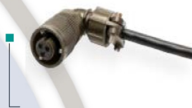
Готовый кабель CL105 3 x 0,75 мм 2 с 3-х полюсным байонет разъемом 10 SL VG 95234 для соединения под углом 90°
