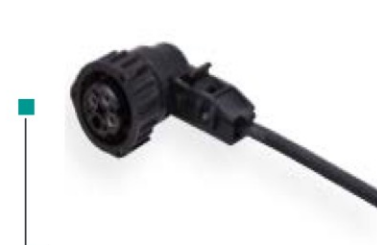
Готовый кабель FL33X33X 3 x 0,75 мм 2 с 4-х полюсным байонет разъёмом ISO 15170 Для соединения под углом 90°
