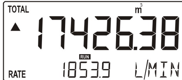
Рис. 3: Пример отображаемой информации во время штатной работы расходомера
