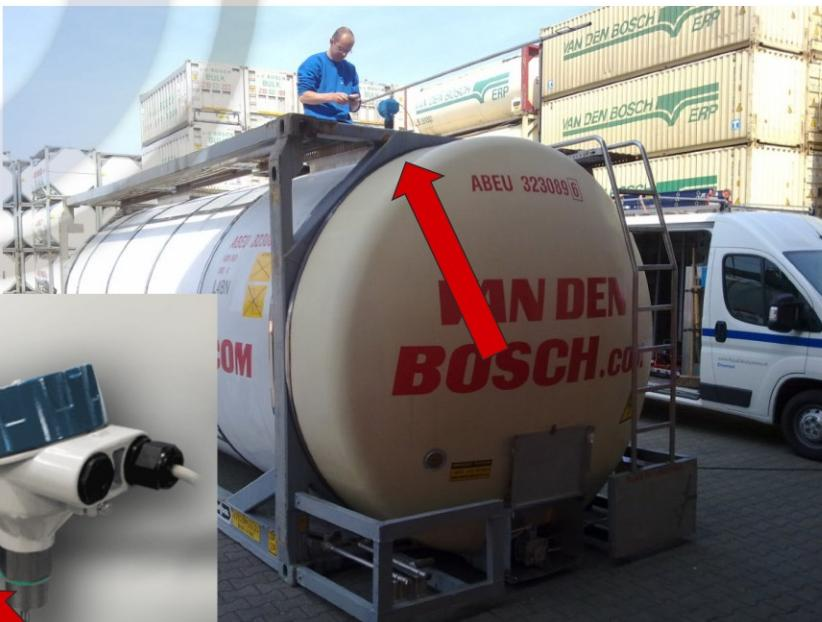
Автономный энергонезависимый коммуникационный GSM модуль по сбору, обработке и передаче данных от первичных приборов учёта. Встроенная батарея сроком службы не менее 3 лет (для южных широт РФ возможна модификация с питанием от солнечного элемента), также осуществляет питание совместимого с модулем ДУТа. Высокопрочный корпус со степенью защиты IP67.
