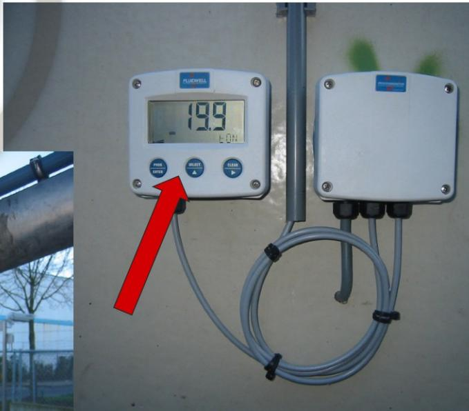
Контроллеры серии «F» предназначены для индикации количества пройденной жидкости через расходомер, а также для дозирования и смешивания с возможностью дистанционного управления. Интерфейсы RS232/RS485, протокол ModBUS. Во взрывоопасных зонах используются устройства «E» серии, сертифицированные по ТР ТС 012/2011 и поддерживающие протокол HART.
